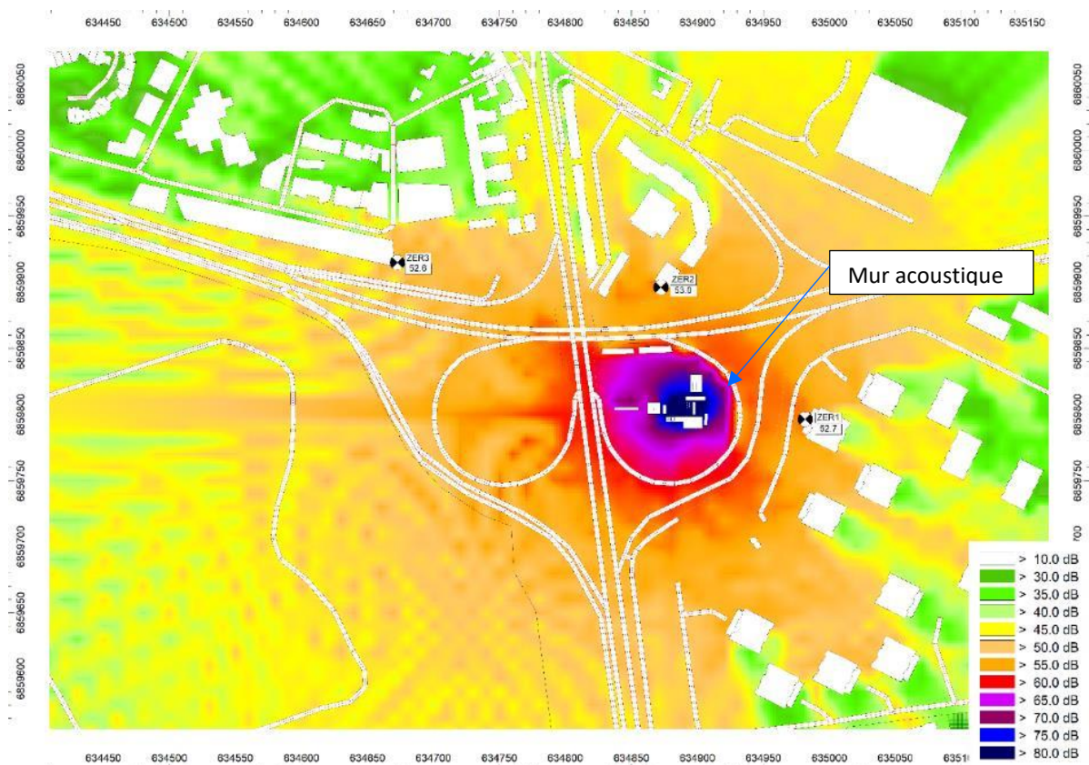
Figure 14 : Carte de bruit du chantier en dB(A) avec optimisation acoustique, calcul à h=1,5m du sol
